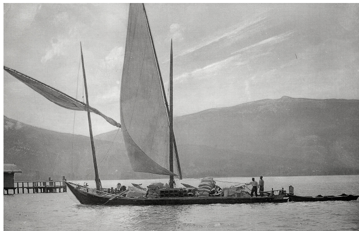
La Comète vue de profil dans la baie de Talloires. Le trinquet est encapelé autour de son antenne. La voilière passe devant le grand voilier : du point de vue de la manœuvre, on dit qu'on est sur la fausse main (ou mauvaise main ) car si son antenne est aplanée sans prendre de précautions, la bordure inférieure de la voile risque de se tendre autour du mât et de se déchirer
