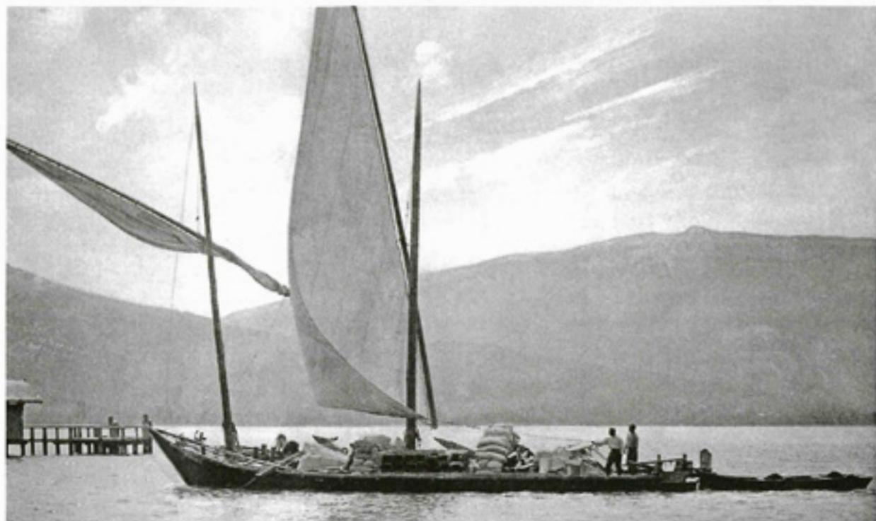
La Comète est au vent arrière, dans la baie de Talloires. Le trinquet est serré sur son antenne, seule la voilure est déployée; comme dans la disposition en « oreilles d'Anancy », l'antenne en demeure bien apiquée, ce qui l'autorise à tourner autour du mât sans dégât si la voile est prise à revers.
